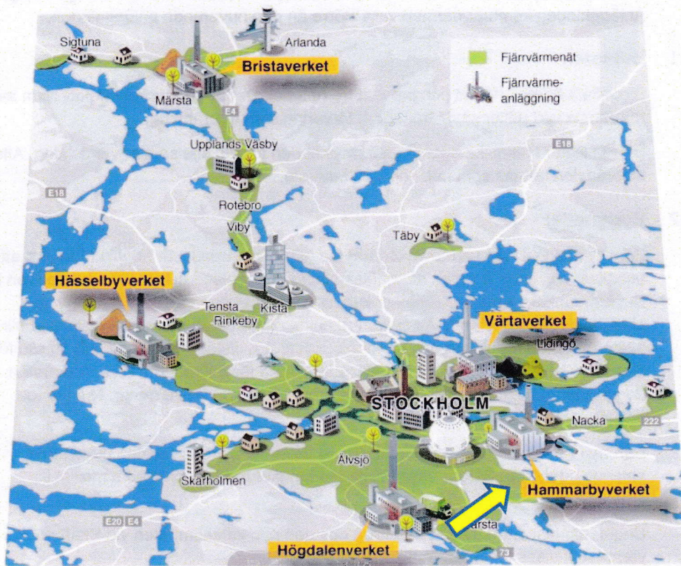
Figur 1 Fjärrvärmeanläggningar i Stor-Stockholm. Bilden visar det sammankopplade fjärrvärmesystemet i Stockholm där Skarpnäck värmeverk utgör en spets- och reservlastanläggning. Platsen för värmeverket markeras av den gula pilen.
